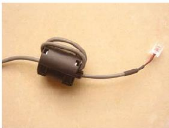
Рис.29 Местоположение подключения коннектора, линии связи и магнитного кольца
