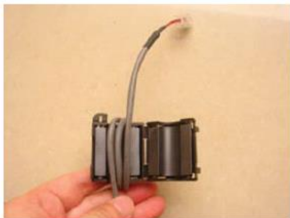
Рис.28 Способ подключения коннектора, линии связи и магнитного кольца
