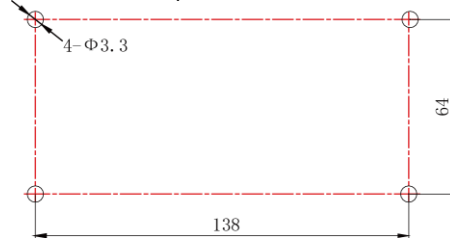
Рис. 1.9 Монтажные отверстия на тыльной крышке электрической секции
