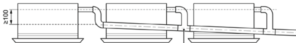
Дренажные трубы с тройниками
