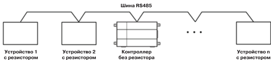
Рис. 5.6 Положение оконечных резисторов в сети RS485 доступа к контроллеру
