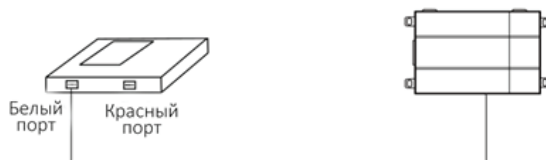
Рис. 7.8 Подключение коммуникационного кабеля от контроллера до проводного пульта водонагревателя
