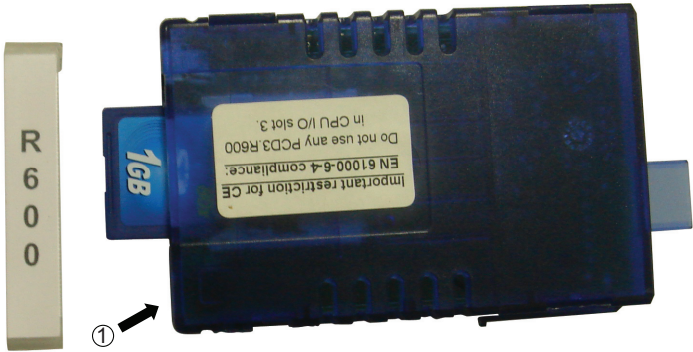
图 2-4 PCD 控制器 (WEB SERVER 模块)PCD3. R600 装入 SD 卡图
