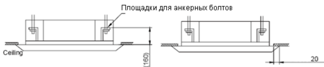
Рис.2 Анкерные болты для монтажа корпуса блока
