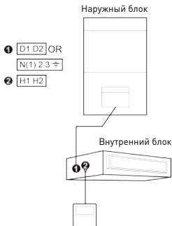
Рис. 4.4 Один проводной пульт управляет работой одного внутреннего блока
