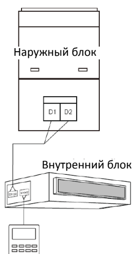
Рис. 3.3 Один проводной пульт управляет работой одного внутреннего блока.
