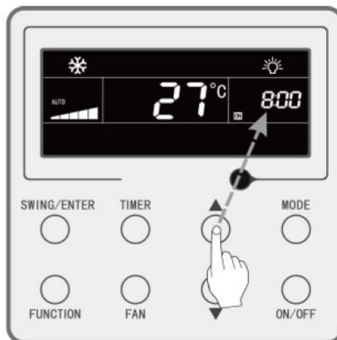
Кнопкой TIMER перейти к времени выключения. Кнопками ▲ или ▼ задать время включения по таймеру.
